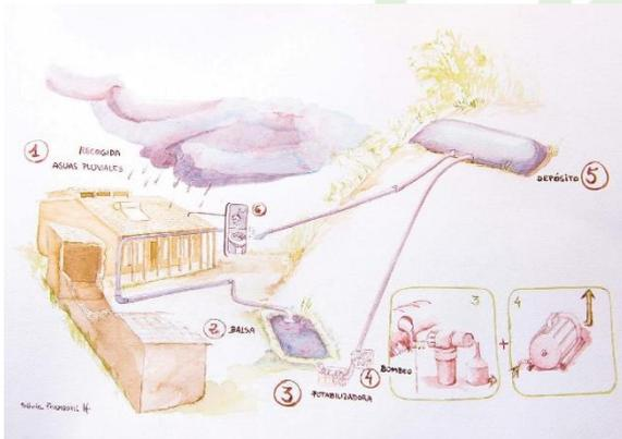
Este circuito nos permite obtener un agua de calidad que posteriormente utilizamos tanto para el riego del huerto y ajardinamiento, como para el abastecimiento de la vivienda, en este caso el agua se filtra, depura y esteriliza antes de almacenarla en unos depósitos estanques de abastecimiento.
